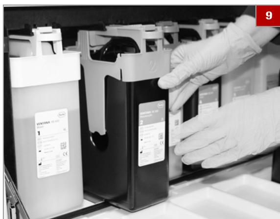
9 Aligned l'ensemble flacon/capuchon sur son support et glissez le conteneur pour le positionner jusqu'à ce que la languette de verrouillage s'engage.
