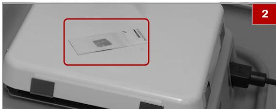
**2** Placez la lame sur la plaque chauffante durant 10 secondes ou plus.
