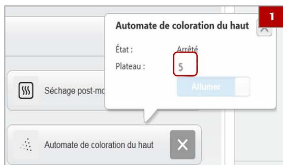
1 Pour déterminer l'emplacement des plateaux restants, sélectionnez l'onglet **Instrument**, puis sélectionnez chacun des modules du système.
