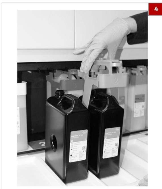
4 Placez le capuchon de réactif sur le flacon correct.
