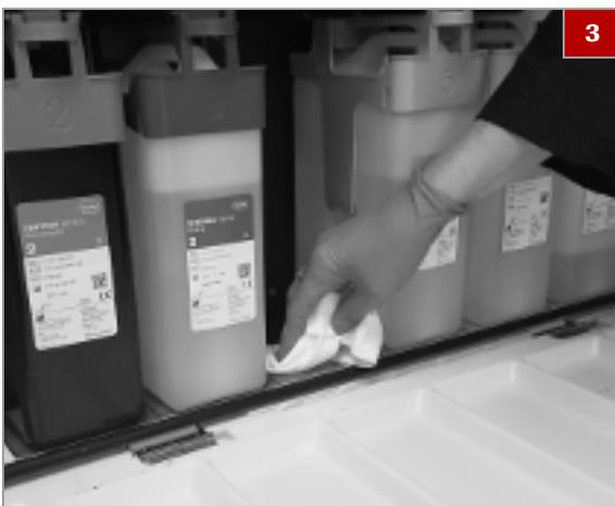
**3** Si nécessaire, nettoyez le tiroir avec un chiffon humide propre.
