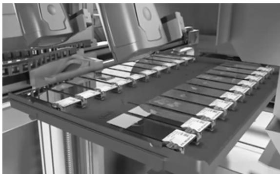
Le module de détection des lames émet un faisceau de lumière sur les extrémités des étiquettes des lames pour déterminer l'emplacement des lames sur un plateau. Seuls les emplacements du plateau où se trouvent les lames sont traités dans les modules suivants de coloration et de recouvrement.
