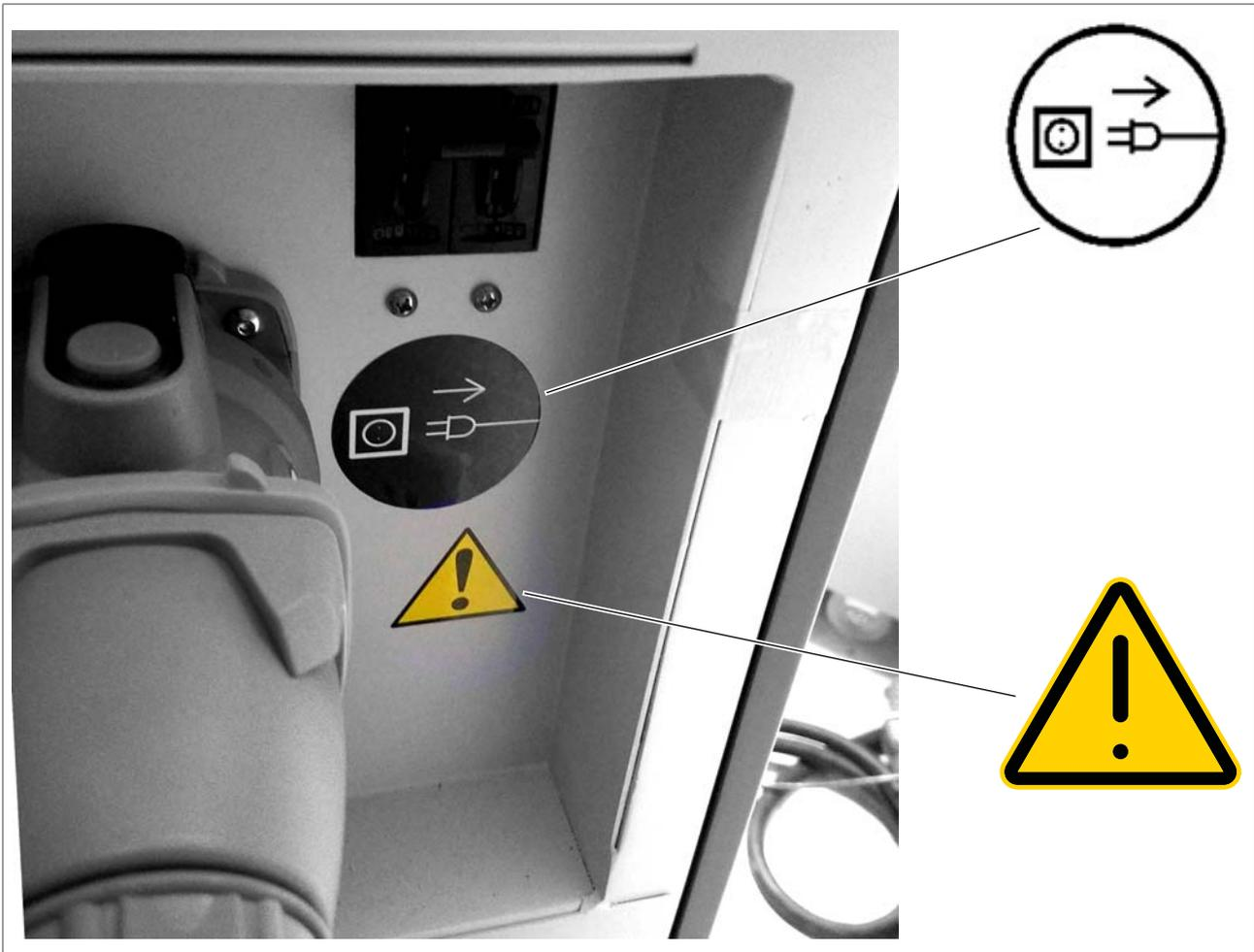
Étiquette du cordon d'alimentation à proximité du cordon d'alimentation à l'arrière du système.
