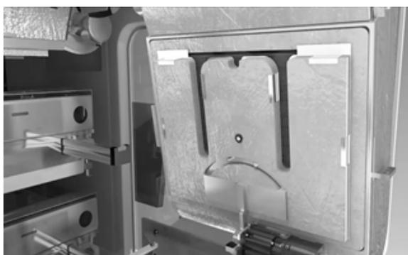
Le four incline le plateau de lames à un angle de 80° pour permettre à l'humidité des lames de s'échapper. Le plateau est ensuite chauffé dans le four à une température de 72 °C (+/- 3 °C.).
