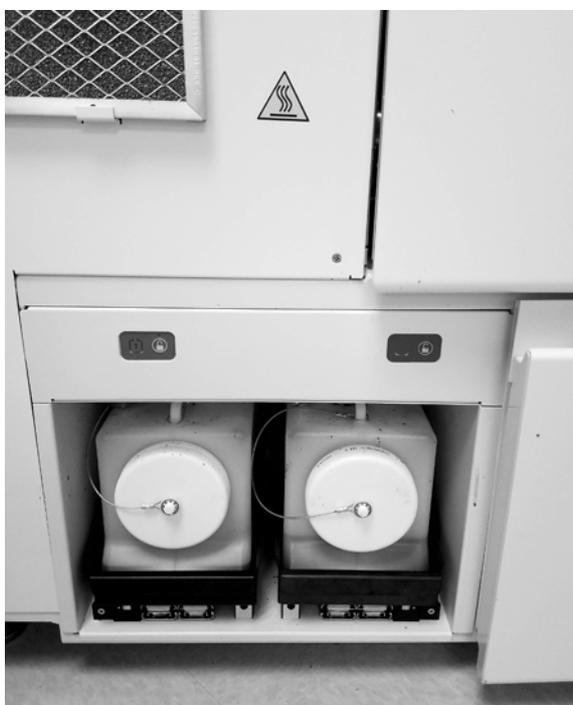
Les laboratoires observent des réglementations et des consignes différentes en matière d'élimination des déchets liquides. Les laboratoires qui n'éliminent pas les déchets liquides à l'égout utilisent un module de capture des déchets embarqué.
