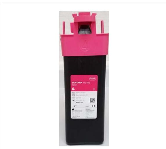
Les réactifs sont expédiés et conservés dans des flacons jetables portant des étiquettes de couleur et numérotées. Ces étiquettes correspondent à la couleur et au numéro indiqués sur le capuchon des réactifs et sur l'icône **Fonctionnement** dans l'écran tactile.
