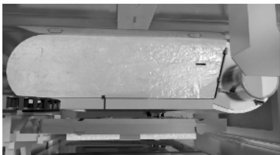
La température de l'étuve est de 92 °C (+/- 3 °C). Une fois que les lames sont durcies, le plateau de lames se replace dans le portail des plateaux. Le plateau refroidit dans le portail afin que vous puissiez le retirer du système. Les lames sont prêtes à être revues après avoir été déchargées d'un portail de plateaux.
