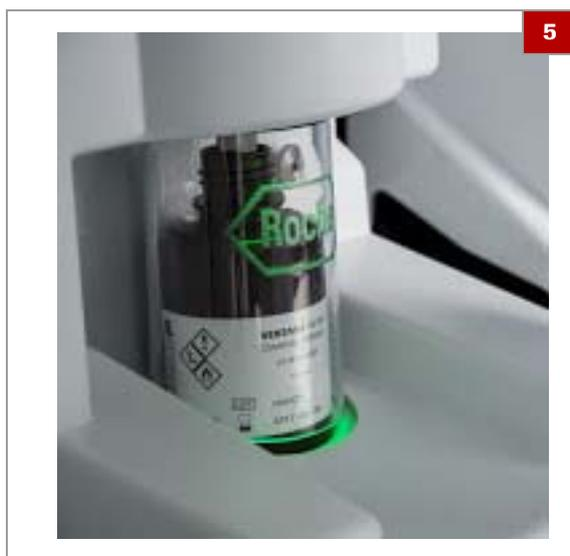
5 Lorsque le flacon est en place, le capot en plastique s'abaisse et recouvre la totalité du flacon. Lorsque le système utilise coverslip activator, le logo Roche est vert.
