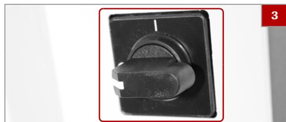
3 Pour préparer la récupération des plateaux, arrêtez le système en utilisant le **Gestionnaire de tâches** et tournez l'interrupteur d'alimentation de I à O. Pour plus d'informations, voir « Arrêter le système » (☞ 176).
