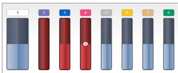
Pour une utilisation plus efficace des réactifs, ne remplacez les flacons de réactif que lorsque les indicateurs d'état des réactifs passent au rouge dans l'onglet **Fonctionnement**, indiquant que les flacons de réactifs sont vides.
