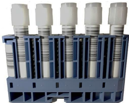
Obr. 1 Správné umístění vzorkových zkumavek ve stojánu MPA před sonikací
