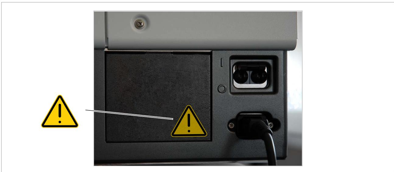
☑ Étiquette de sécurité sur le disjoncteur de l'analyseur
