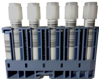
Figura 1 Posizionamento corretto delle provette campione sul rack MPA prima della sonicazione
