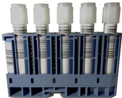
Rys. 1 Prawidłowe umieszczenie probówek na próbki w statywie MPA przed sonikacją
