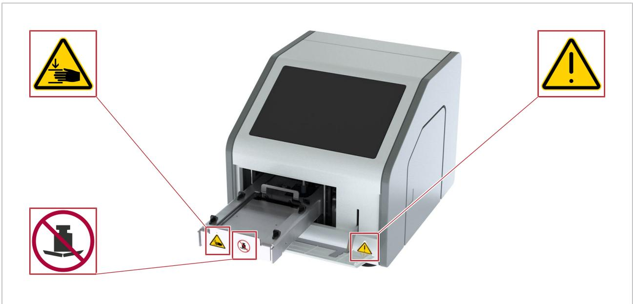
☐ 分样机上的安全标签（纳米孔板抽屉打开的前视图）
