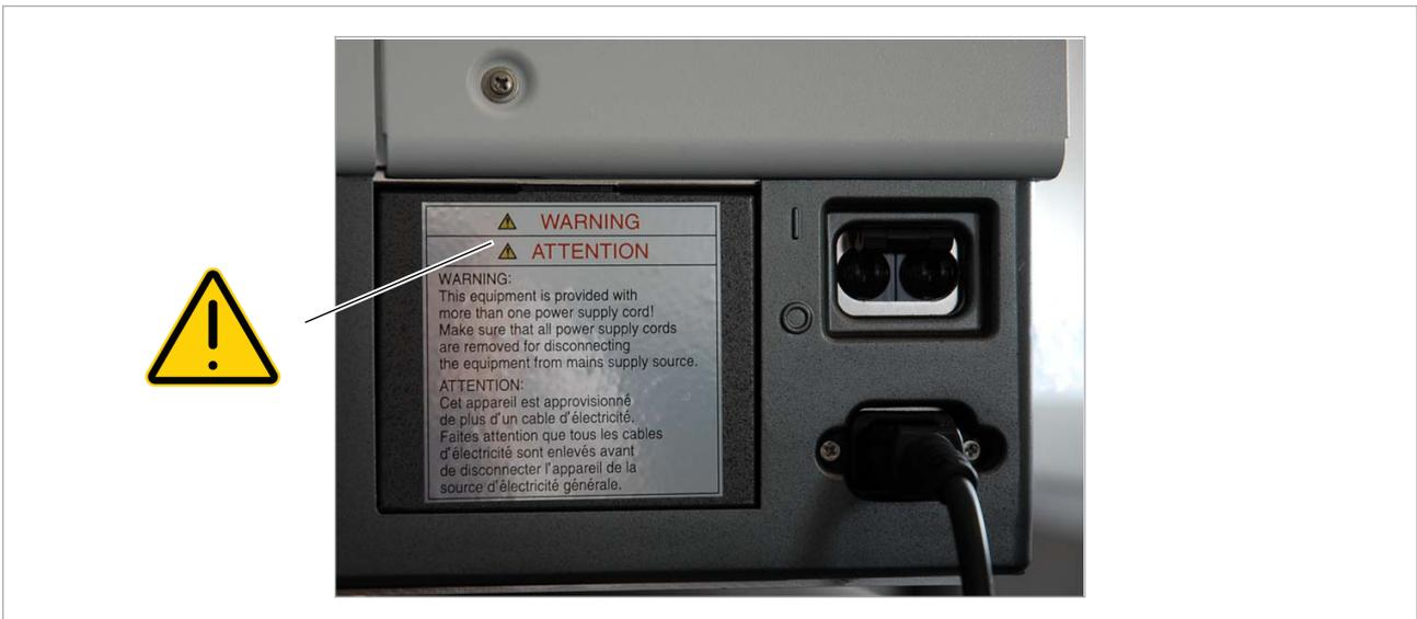
Étiquettes de sécurité sur le disjoncteur de l'analyseur
