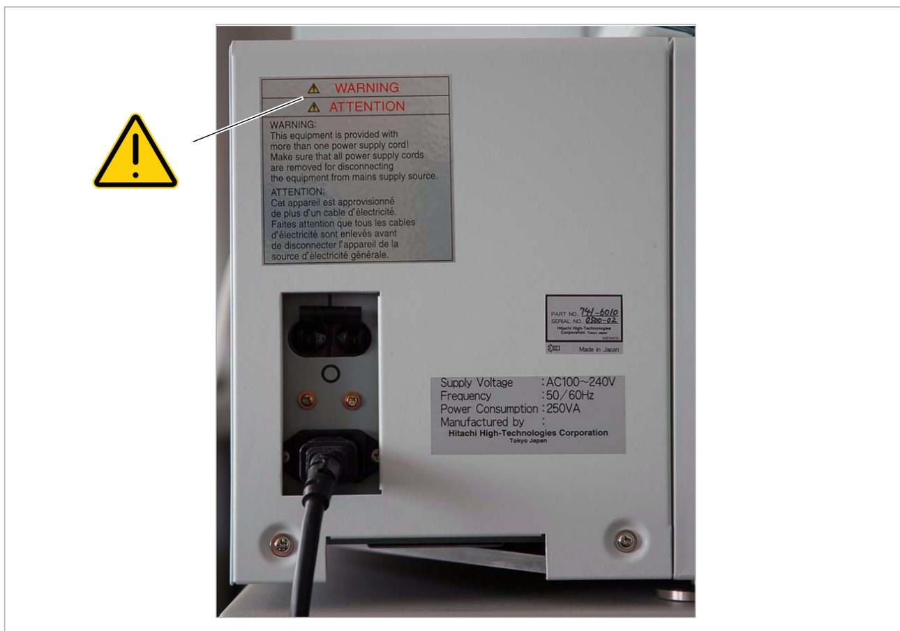
Étiquettes de sécurité sur le disjoncteur de l'échantillonneur de racks
