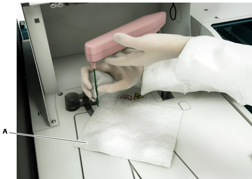
**A** Foglio di carta assorbente collocato a protezione delle aperture delle vaschette di diluizione ISE
