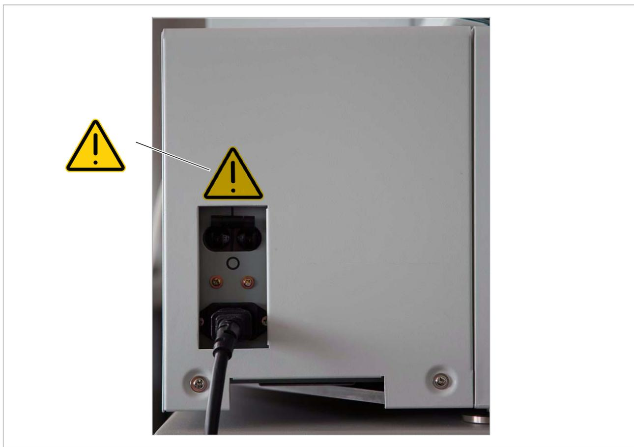
Etichette di sicurezza sull'interruttore differenziale di sicurezza dell'analizzatore (sistema rack)
