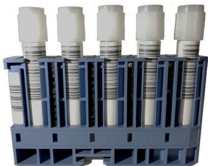
Bild 1 Korrekt placering av provrör i MPA-rack innan sonikering
