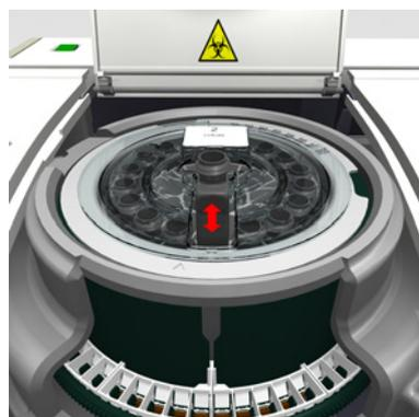
**Figure A-22** Manipulation d'un flacon de réactif
