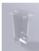
Toutes les mesures optiques utilisent les mêmes réservoirs en plastique transparent appelés cuvettes. Les échantillons sont automatiquement transférés du tube échantillon aux cuvettes situées sur la couronne à cuvettes.
