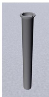
Une cheminée est une sorte de canule qui, insérée dans un flacon, permet de réduire l'évaporation.
