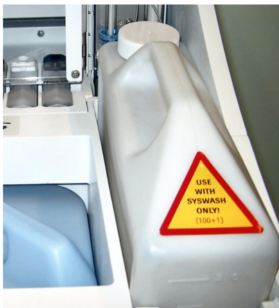
Figura A-55 Contenedor de agua del sistema
