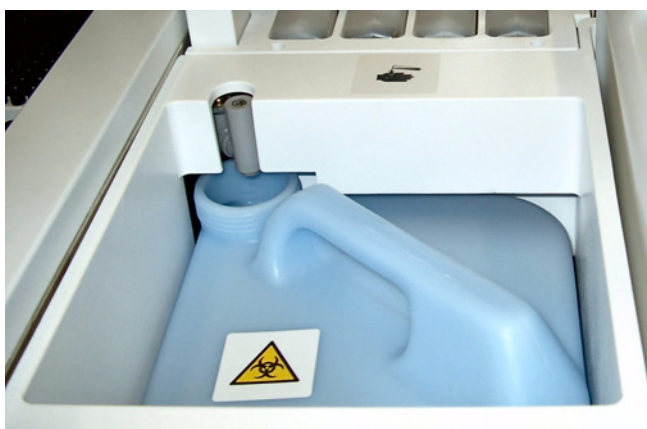
Figura A-56 Contenedor de residuos líquidos
