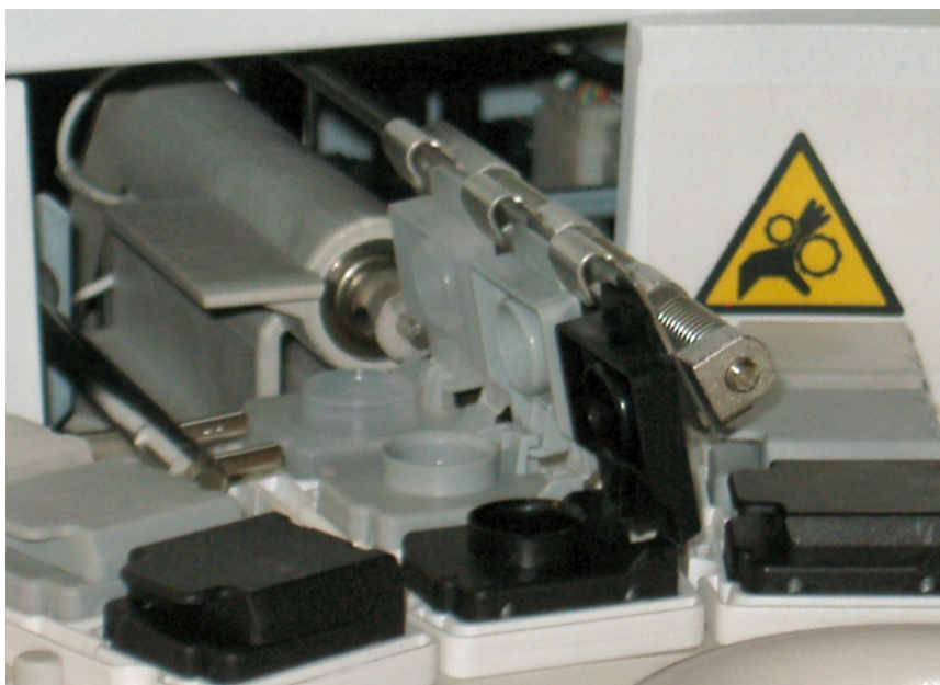
Figura A-48 Mecanismo de apertura y cierre de tapas de reactivo
