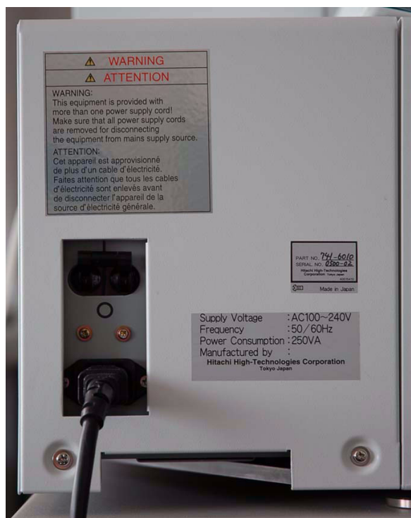
Figura A-5 Ubicación de etiqueta de seguridad: interruptor general del sistema de muestreo de racks
