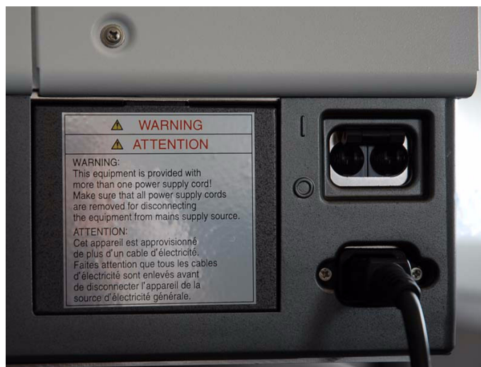
Figura A-4 Ubicación de etiqueta de seguridad: interruptor general
