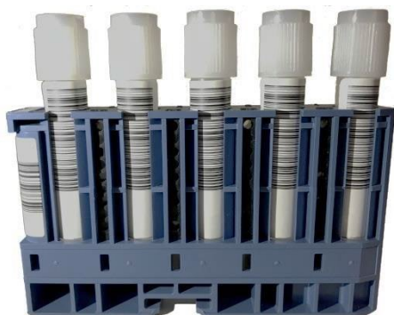
Bild 1 Korrekt placering av provrör i MPA-rack innan sonikering
