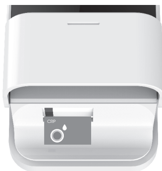
Muestra que cubre el área de aplicación de la muestra
