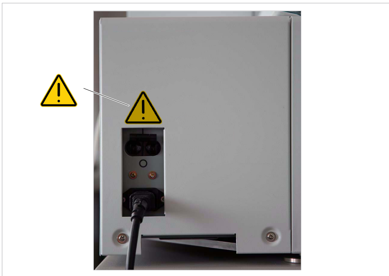
Bezpečnostní štítky na jističi analyzátoru (stojánkový systém)
