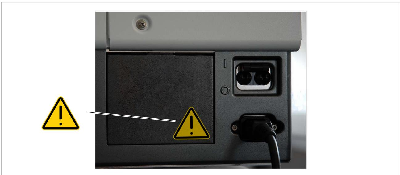
Etiqueta de seguridad en el interruptor de alimentación del analizador
