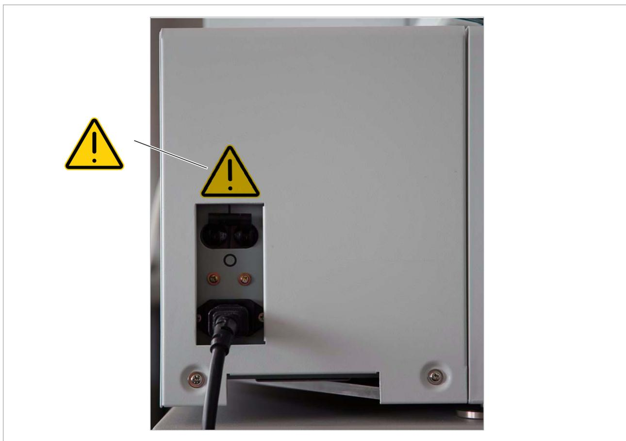
Etiquetas de seguridad en el interruptor de alimentación del analizador (sistema de rack)
