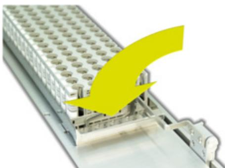
Abbildung 13: Zufuhrhebel herunterstellen
