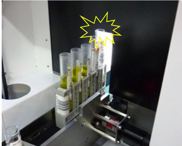
Abbildung 25: Herausstehendes Röhren verklemmt sich an der Rackabfuhr
