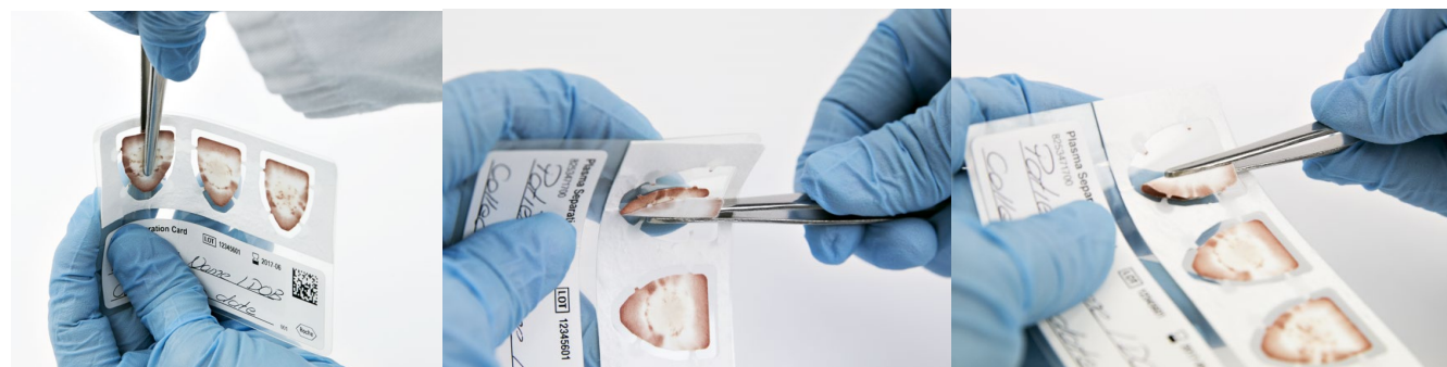
Figura 7 Rimozione dello spot di plasma essiccato piegando il cartoncino PSC
