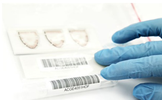
Figura 5 Etichettatura della provetta con il barcode corrispondente del campione PSC
