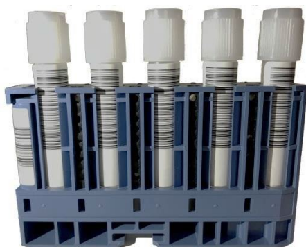
Figur 1 Korrekt placering af prøverør i MPA-racket før sonikering
