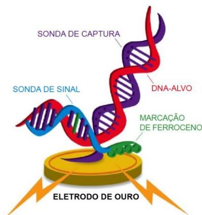
**Figura 1:** Complexo de hibridização. Sondas de captura específicas para o alvo se ligam aos eletrodos de ouro no microarranjo eSensor no cartucho ePlex. O DNA-alvo amplificado se hibridiza à sonda de captura e a uma sonda de sinal complementar marcada com ferroceno. Análise eletroquímica determina a presença ou ausência de alvos usando voltametria.
