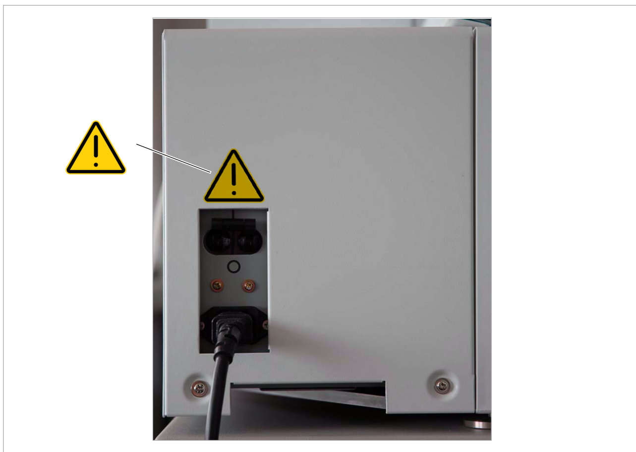
Etichete de siguranță pe întrerupătorul principal al analizorului (sistem cu stative)
