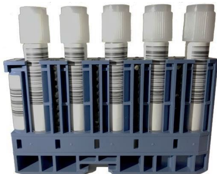
Ilustración 1 Colocación correcta de los tubos de muestra en un rack MPA antes de la sonicación
