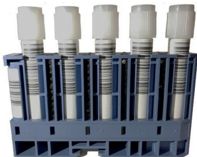
Figur 1 Riktig plassering av prøverør i MPA-rack før sonikering
