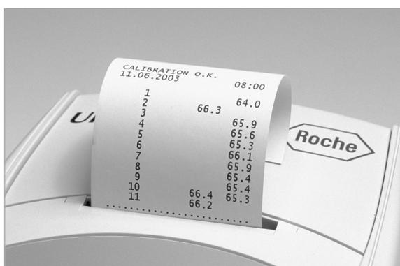
Si les nouvelles valeurs de calibration se situent dans le domaine autorisé, l'appareil imprime automatiquement le message **CALIBRATION O.K.** avec date et heure et indication des valeurs de réflectance des positions de mesure 1 à 11 pour la LED orange (colonne du milieu), et pour la LED verte (colonne de droite).
