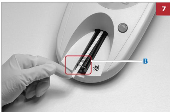
7 ⚠ **ATTENTION** : Vérifier que la barrette de maintien est bien rabattue et que la bandelette est bien positionnée. Si la bandelette n'est pas positionnée exactement au milieu de la glissière pour bandelette, la déplacer légèrement de côté jusqu'à ce qu'elle soit correctement alignée (B). Lors de cette opération, la glissière pour bandelette ne doit pas être déplacée.
