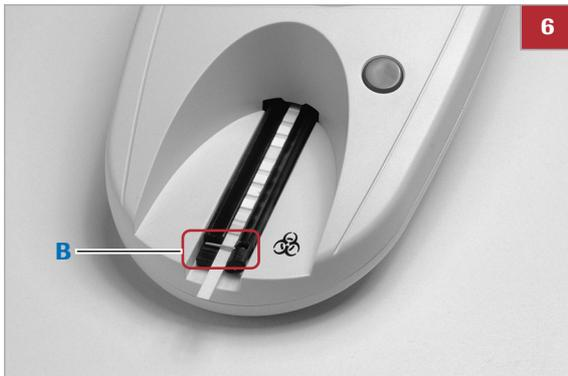
6 Après la période de préchauffage, la glissière pour bandelette pénètre en partie dans l'appareil, la barrette de maintien (B) s'abaisse et la mesure de la zone de référence commence.
