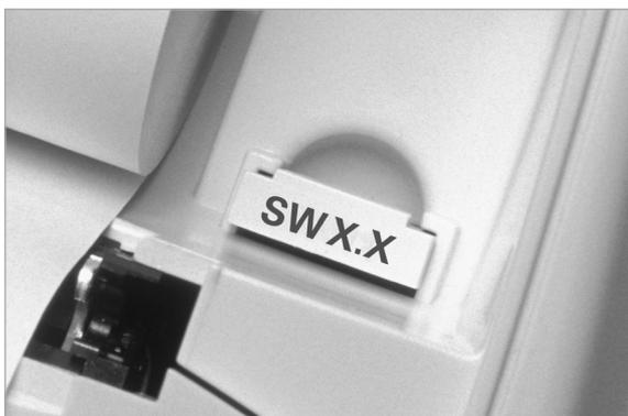
La puce de programmation située à droite de l'appareil au-dessous du couvercle de l'imprimante manque, a un faux contact, est défectueuse ou utilise une ancienne version du logiciel.
