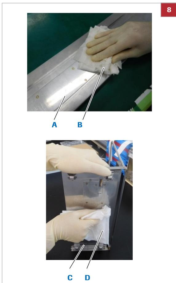
**8** Протрите нижнюю поверхность лотка для штативов, начиная от центра в обоих направлениях, с помощью сложенной безворсовой ткани толщиной не менее 10 мм, смоченной спиртом.
