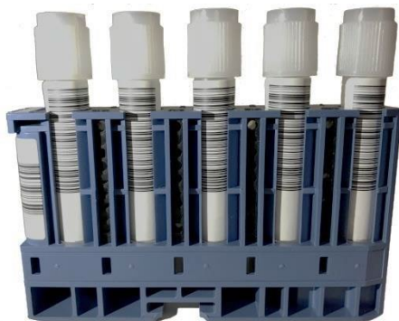
Abbildung 1 Korrekte Platzierung von Probenröhrchen im MPA-Rack vor der Ultraschallbehandlung
