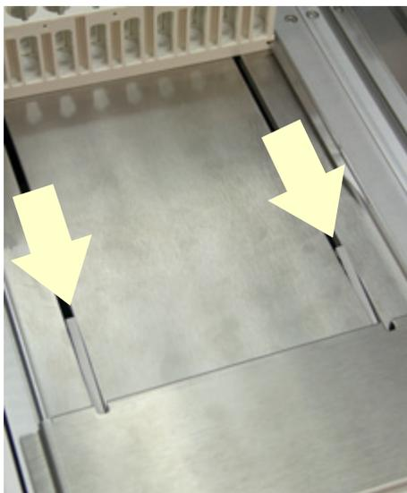
Figura 16: Los mecanismos de empuje se están retirando
