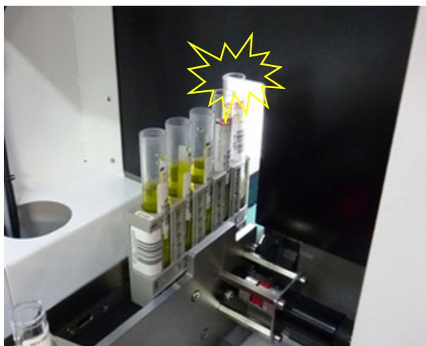
Figura 25: Un tubo que sobresale dificulta la salida de racks
