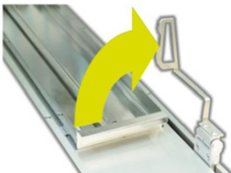
Figura 14: Colocando la pala de suministro en posición vertical.
