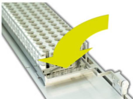
Figura 15: Colocando la pala de suministro en posición horizontal
