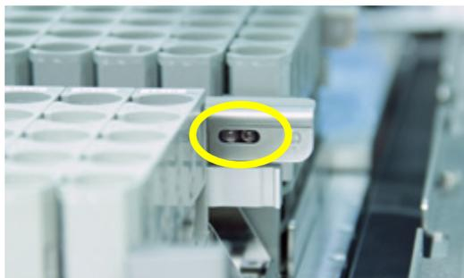
Figura 21: Posición de transferencia (Hitachi)
