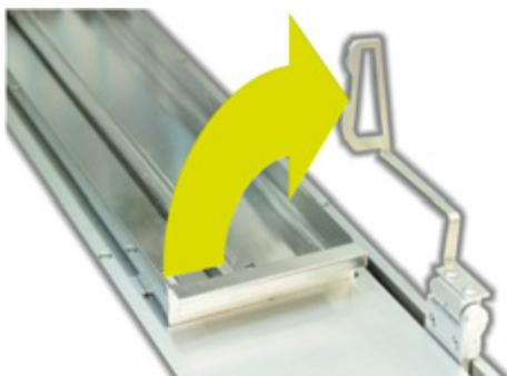
Figura 12: Colocando la pala de suministro en posición vertical.
